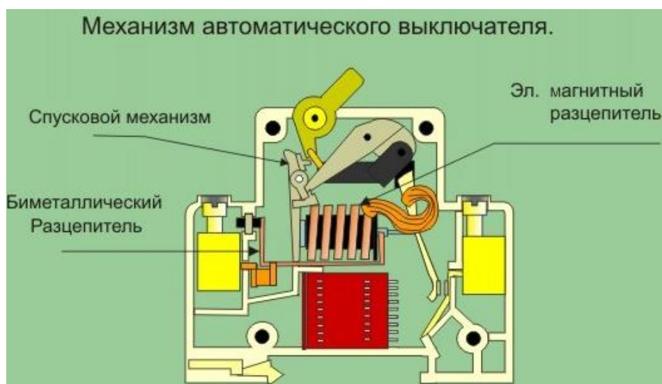
Рисунок 2.1 – Устройство автоматического выключателя
